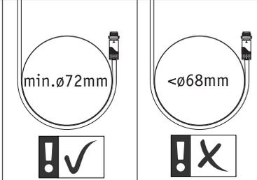
min.  $\varnothing 72\text{mm}$
