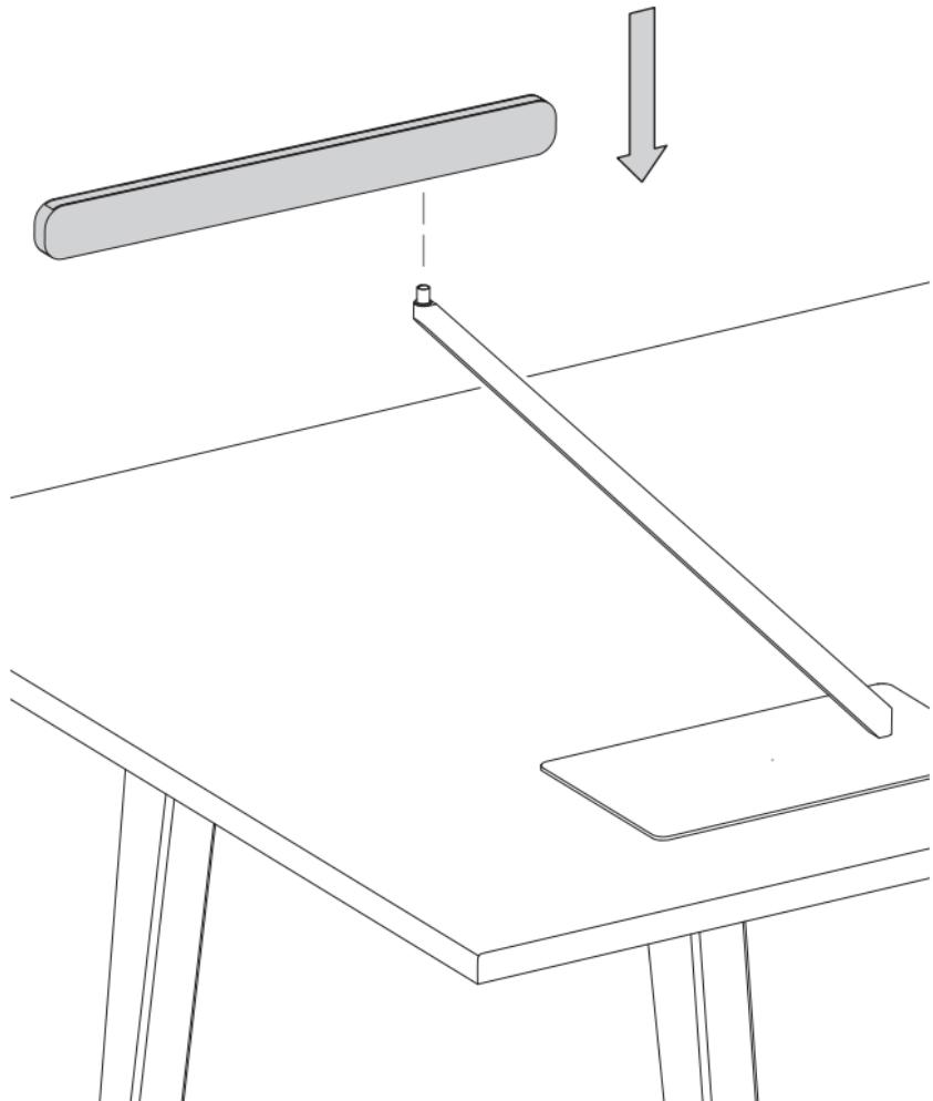
Buchse ausklappen und Kabel einstecken.
