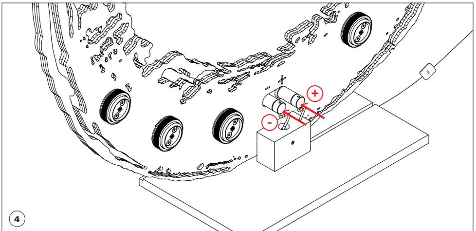
sostituzione LED / LED replacement
