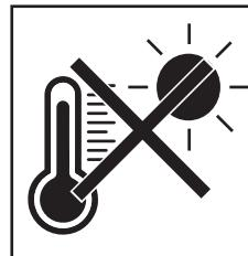
**ITA.** Alte temperature ambientali provocate da condizioni climatiche estreme o da altre fonti di calore riducono la durata e l'efficienza della componentistica o del modulo LED.
