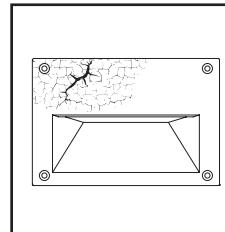
**ITA.** Durante il montaggio e la manutenzione degli apparecchi è necessario prestare particolare attenzione a non danneggiare la verniciatura a polvere. Un danno combinato all'azione dell'acqua potrebbe provocare la corrosione. I prodotti chimici danneggiano la protezione anticorrosione.
