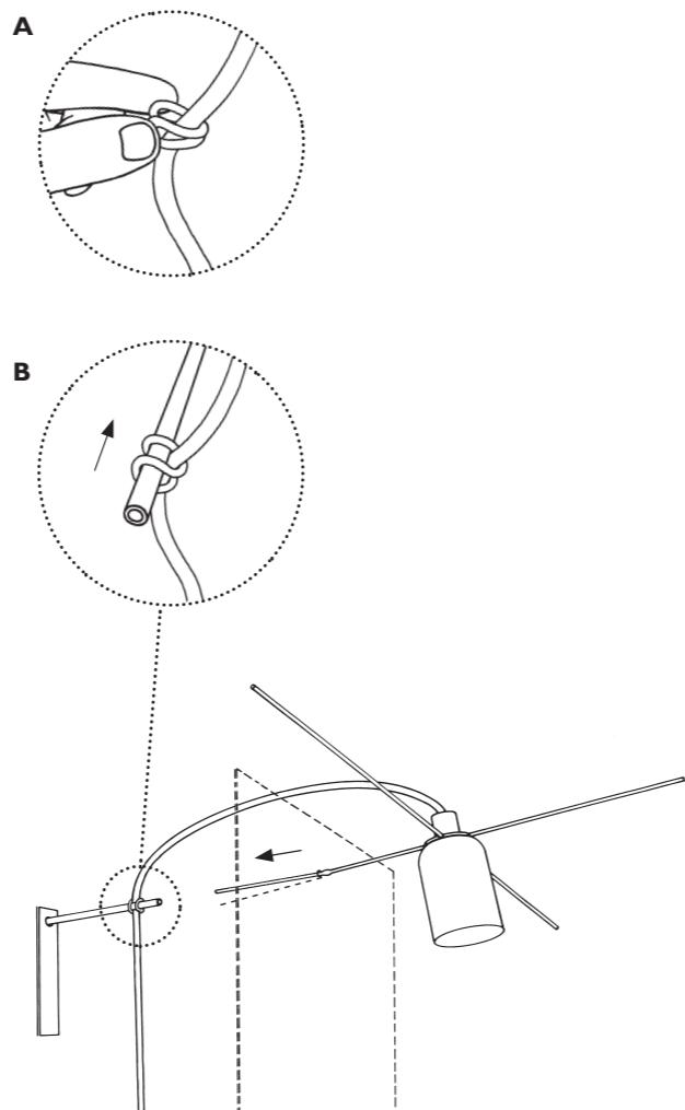
Stabkreuz mit Blende einstecken / Inserting cross bar with
