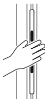
beide Sensoren lange mit der Handfläche berühren touch both sensors with the palm of your hand for a time
