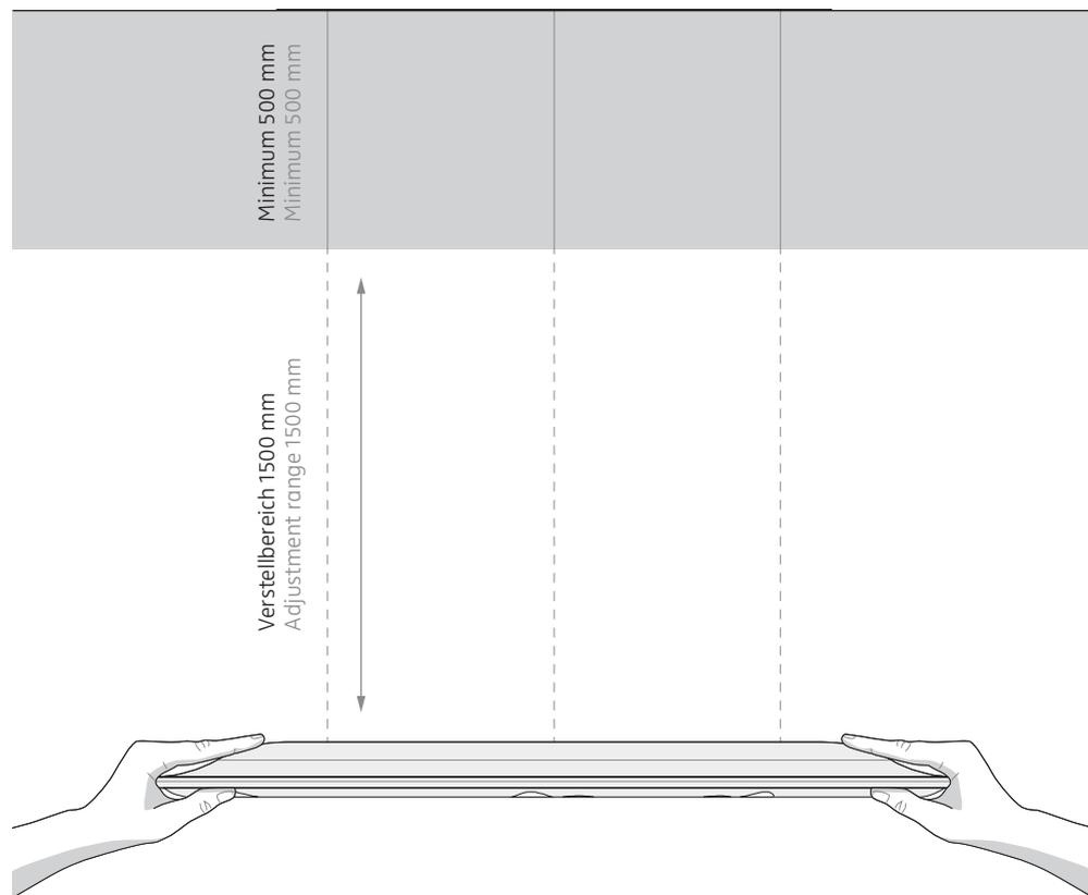
Dank des integrierten Vario Mechanismus lässt sich die gewünschte Pendellänge spielend leicht in einem Bereich von 1500 mm verstellen: Dazu einfach die Leuchte mit beiden Händen auf- oder abwärts führen. Thanks to the integrated vario mechanism, it is easy to change the desired pendant length over a range of 1500 mm: simply move the luminaire up or down with both hands.
