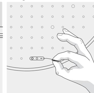
Drücken Sie die Pairing-Taste. Die rote LED blinkt, wenn die Leuchte zum Koppeln mit der Höfele-App\* bereit ist, und hört auf zu blinken, wenn das Koppeln erfolgreich ist. Drücken Sie die Taste erneut, um den Pairing-Modus zu verlassen.
