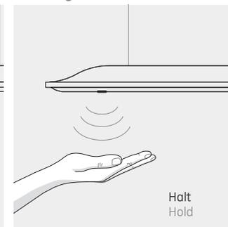
Lassen Sie die Hand unter dem Sensor schweben damit die Leuchte langsam hoch oder herunter dimmt. Die Dimmrichtung wird mit jedem Schaltvorgang geändert.
