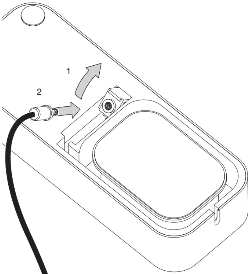
Buchse einklappen und Kabel, bis die gewünschte Länge erreicht ist, aufwickeln.
