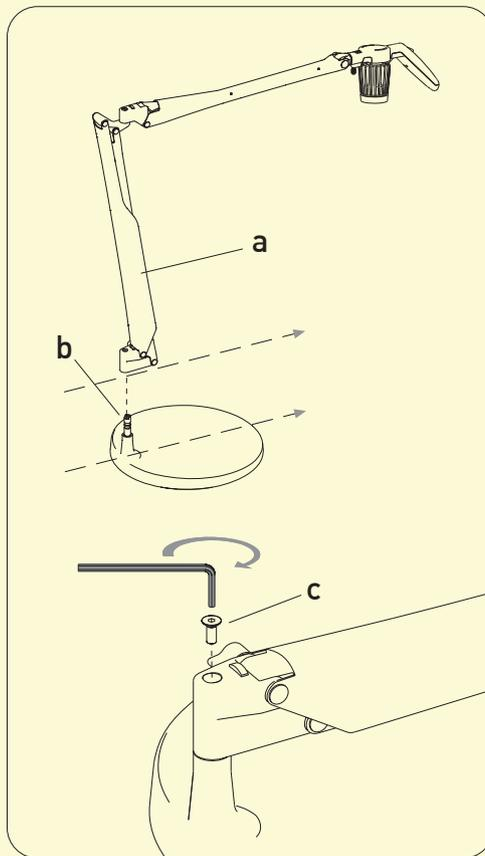
Inserire la lampada (a) sul perno (b) della base (D33N/1), orientandola come in figura.
