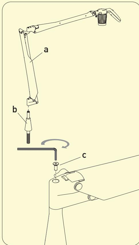
Dopo aver fissato l'attacco tavolo per passacavi da scrivania, inserire la lampada (a) sul perno (b) dell'attacco (D33N/5). Distendere il braccio in orizzontale ed avvitare la vite (c) mediante la chiave esagonale in dotazione.
