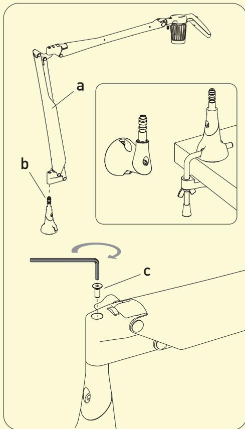
Dopo aver fissato l'attacco universale (a parete, o a tavolo con o senza morsetto), inserire la lampada (a) sul perno (b) dell'attacco universale (D33N/3). Distendere il braccio in orizzontale ed avvitare la vite (c) mediante la chiave esagonale in dotazione.
