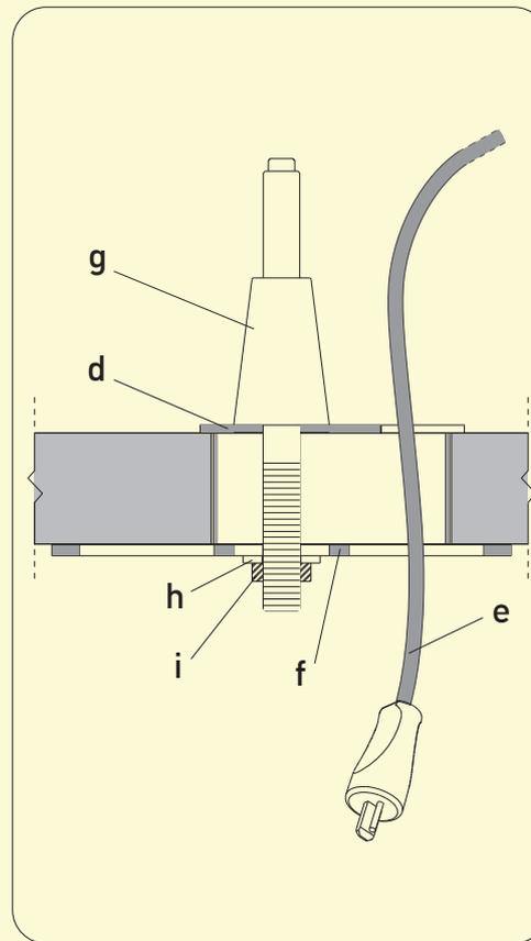
Praticare un foro passante da 11 mm sul passacavo da scrivania metallico (d). Fare passare il connettore punto linea (e) della lampada da installare attraverso il passacavo da scrivania (d) e la contropiastra (f). Inserire il perno tavolo (g) nel foro, inserire inferiormente la contropiastra (f) sul filetto (g). Bloccare l'assieme con la rondella (h) ed il dado (i). Per evitare deformazioni al passacavo metallico (d) assicurarsi di non serrare eccessivamente il dado (i).
