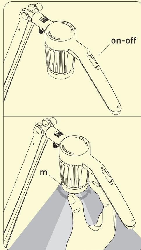
Per regolare l'angolo di emissione da 80° a 45° della sorgente a led, agire sulla ghiera (m) ruotandola.
