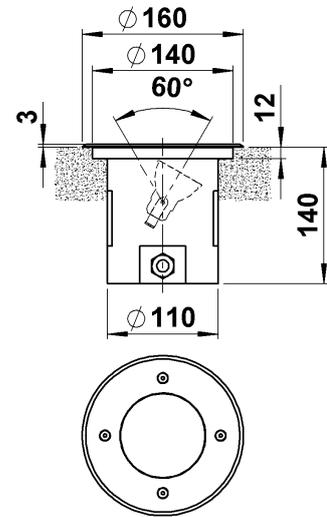
**Konstruktion:** Aluminiumgehäuse mit Edelstahl-Blende
