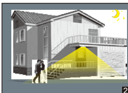
Ist das Umgebungslicht nicht ausreichend, schaltet der Sensor die Lampe an, sobald eine Bewegung erkannt wird.
