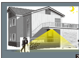
Con luz ambiente insuficiente, el sensor conecta la lámpara si se detecta movimiento.
