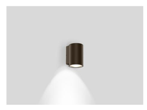
Zylindrische Wandanbauleuchte aus Aluminiumdruckguss; Oberfläche Bronze; pulverbeschichtet; matte Oberflächenstruktur; Lichtabstrahlung nach oben oder unten; mit COB (Chip on Board) Technologie für höchste Effizienz; Phasenschnitt dim; Lichtfarbe 3000 K; Binning initial MacAdam  $\leq$  3 SDCM; CRI  $\geq$  90; 220 - 240 V; Ausstrahlwinkel 36°; Schutzart IP65; SK1; nicht austauschbare Lichtquelle;
