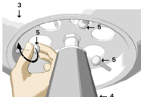
Fissare il diffusore (3) al corpo lampada (4) avvitando le tre viti (5).
