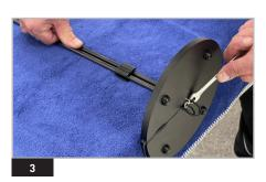
verschrauben sie die mutter mithilfe eines schraubenschlüssels an das gewinde und fixieren sie den teil des dicken kabels im schlitz der bodenplatte. drücken sie beim festziehen mit dem daumen auf die jeweilige carbonstange, sodass die magnetkugeln wie im bild 1 nach oben zeigen.
