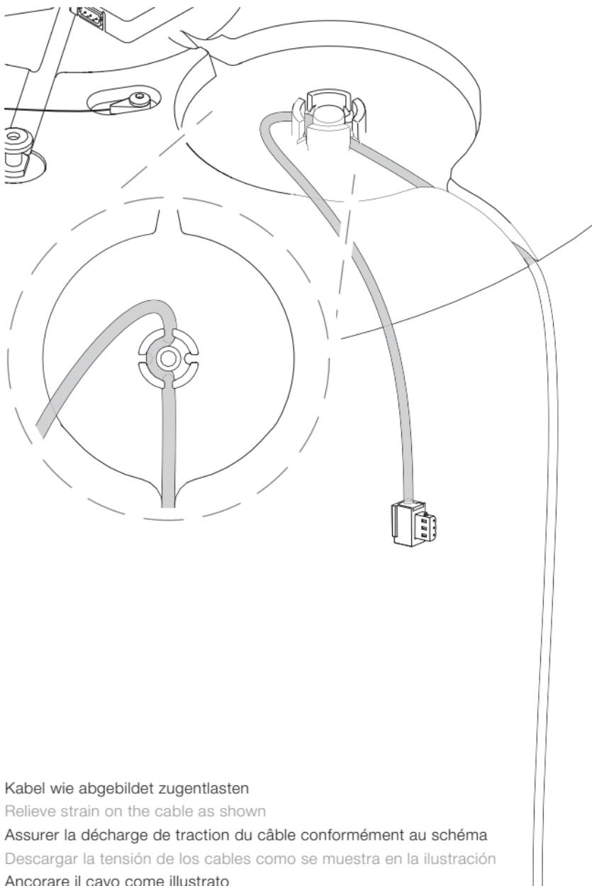
Kabel wie abgebildet zugentlasten
