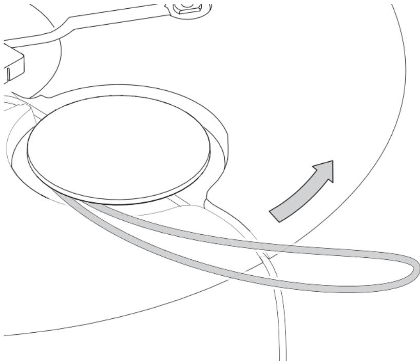
Kabel, wie abgebildet, doppelt aufwickeln
